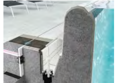
Hochgeführtes Beckenkopfsystem mit Handfasse; Überlauf über Außenwände in Rinne mit Rostabdeckung. Elevated pool edge system with handhold piece; overflow via outer walls into channel with cover grating.
