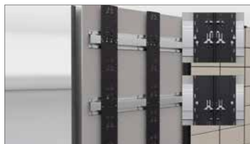
Fijar el perfil Omega con remache ciego de aluminio (Art. 658) o tornillo de acero inoxidable A4 (Art. 659) (observar el punto fijo y flotante)
