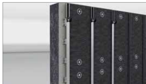
Pegar cinta adhesiva para juntas en los perfiles de carga verticales
