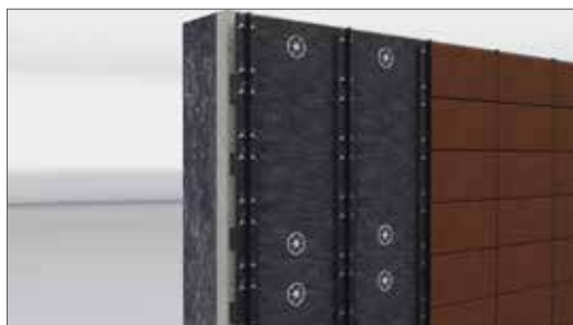
Clip en perfil de junta (para juntas cerradas)
